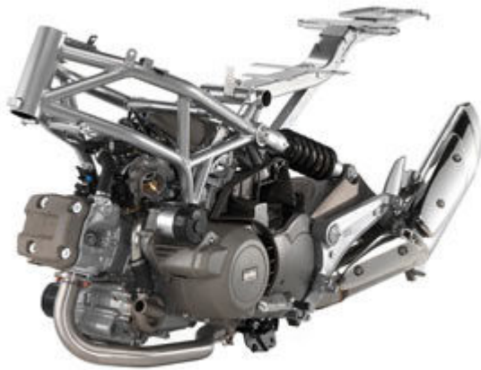
Kräftiger Stahlrahmen, rund ums Antriebsaggregat gebaut. Der V2 stammt von Piaggio. Die Schwinge ist aus Alu, das schräg seitlich angesetzte Federbein lässt Raum für den Auspuff-Endtopf.
