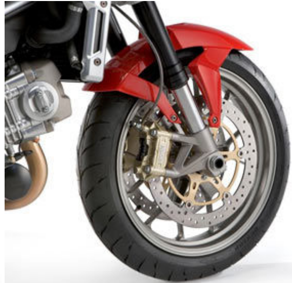
Die NA 850 Mana ist, wie die Shiver 750, kein Bremsen-Stiefkind – deshalb verpasste man auch ihr die feinen Radial-Zangen. Der Druckpunkt ist glasklar, die Wirkung angenehm progressiv.
