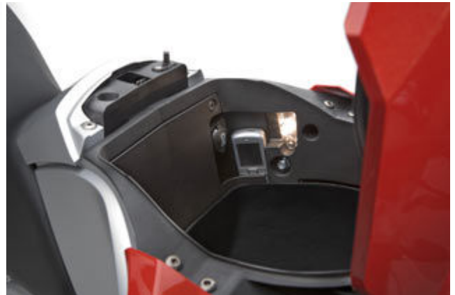
Detail mit Verstand und Sinn für Praktisches: Unter der Tankatruppe sitzt ein veritabler Stauraum mit Platz für einen Integralhelm. Zusätzlich gibt's Handyfach, Beleuchtung und 12V-Steckdose.
